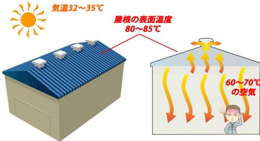
図①のように、この熱い空気が作業をしている所まで来ますと、熱中症になる確率が高くなります。
