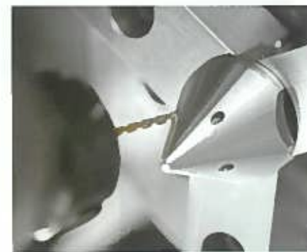
ユニバーサルホルダによる斜め穴加工
