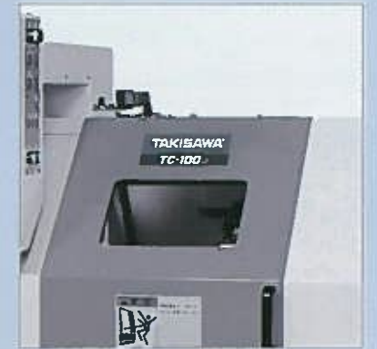
鋼板二重構造のフロントドア。窓は硬質ガラスとポリカーボネートの2枚合わせで安全性を強化
